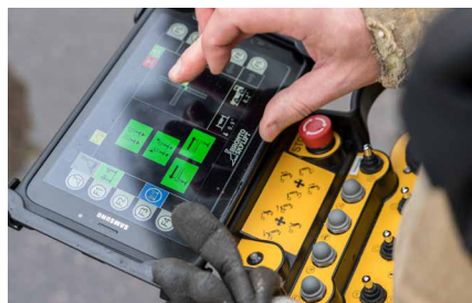
Ein Tablet kann als zusätzliches Display für das Steuersystem in die Fernbedienung integriert werden. (nur Bronto 5+)
