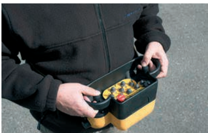
Die Funkfernbedienung ist leicht und benutzerfreundlich. (Gewicht ca. 2 kg)
