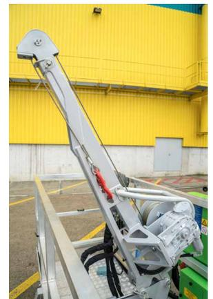
*Um +/- 45 Grad schwenkbarer und ausfahrbarer Hubausleger.*
