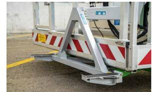
*Standardisierte Korbefestigungspunkte und ausklappbare FüÙe für das Heben.*
